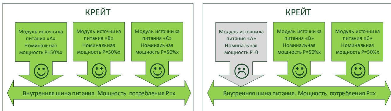
Рисунок 13 - Схема с избыточным модулем источника питания
