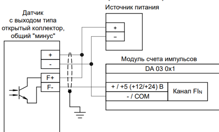
Рисунок Б.5.2 – Схема подключения датчиков с выходом типа открытый коллектор, общий «минус» к модулям счета импульсов
